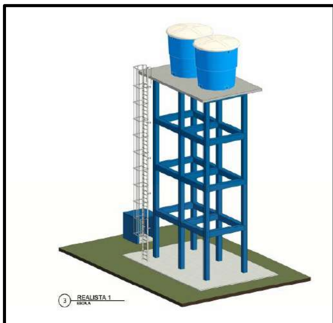
Figura 01: Reservatório Elevado com Casa de Bomba
